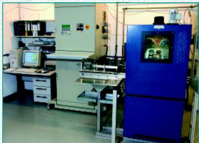
Bild 28: Dauerlaufprüfstand Hydraulik mit Klimakammer
