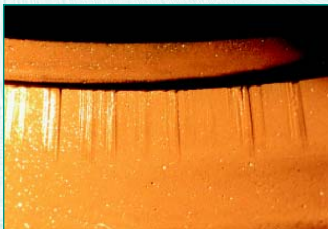
Bild 37: Riefen und Rillen an der dynamischen Dichtlippe
