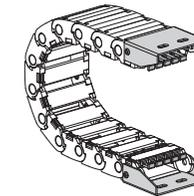
Bild. B Fixierung der Energieführungskette nach außen. (Bild B)
